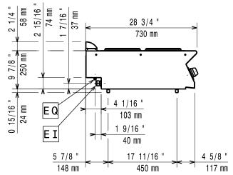
El = Connexion électrique EQ = Vis équipotentiel
